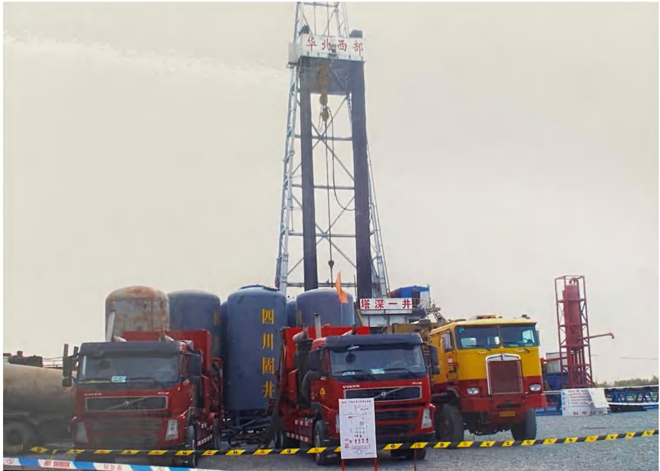
塔深1井固井作业现场
