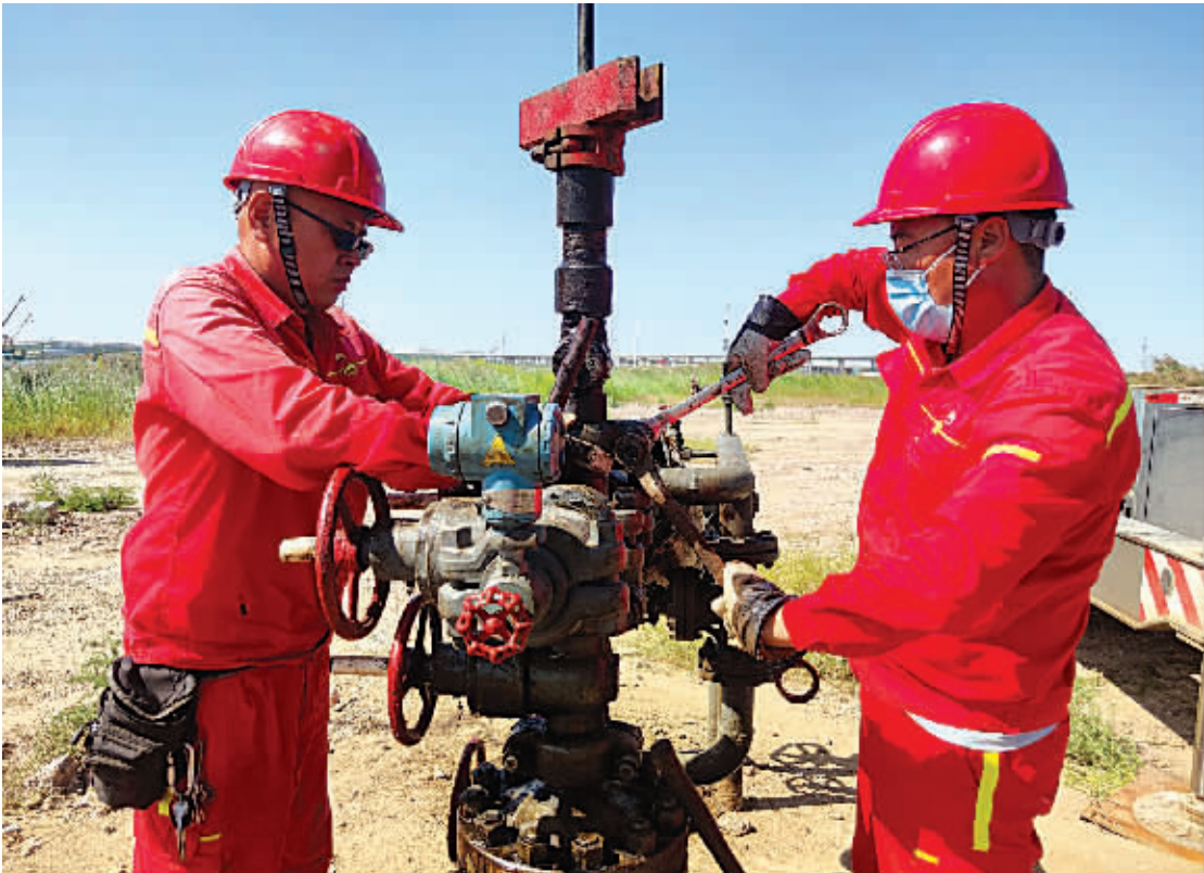
采油一厂作业一区从“五精细管理”方式,全面掌握油水井生产动态,优化护理措施,提升措施效果,加速原油上产步伐。图为作业区员工对异常井港 539-2K 井进行打捞光杆。
