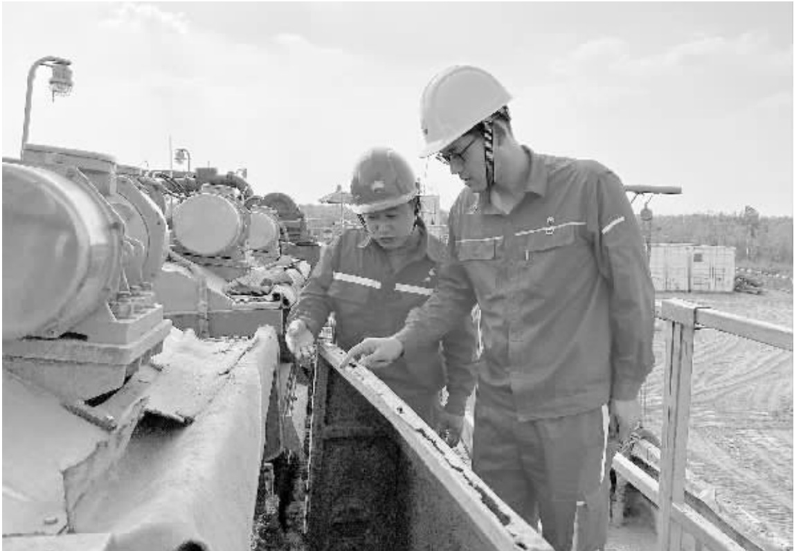
针对港西油田低动用井区，采油五厂技术人员密切跟踪、分析、调整地质导向，确保水平井油层钻遇效果。图为技术人员观察西 14-31H 井钻进过程中的岩屑变化。
