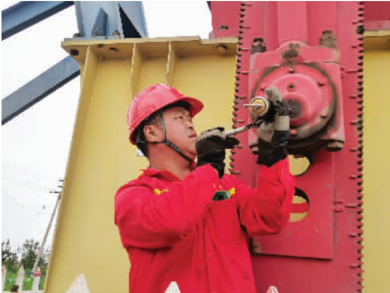
采油五厂员工对抽油机设备保养部位加注黄油。(王秀梅)
