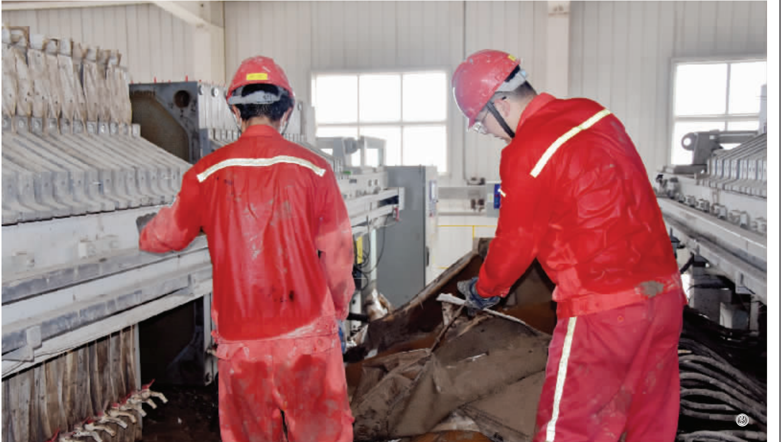
①②③原油运销公司废弃泥浆处理作业区“泥团”战士们相互配合,连续奋战 3 天,拆换 260 块板框压滤机新滤布,确保“两废”处理高质高效。(魏丽萍)
