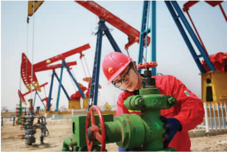
采油五厂作业一区员工正在排查井口有无渗漏现象。(牛娅新)
